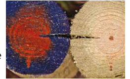
Holzprobe, die den Eindringungsgrad der Behandlung zeigt.
